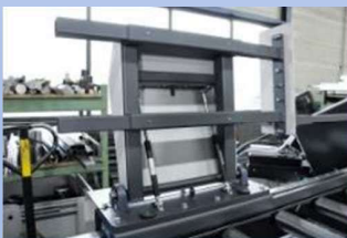
Automatische elektrisches Anheben des Messanschlages (optional)
