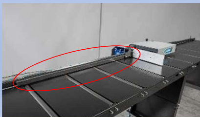
Verlängerung des Anschlags auf 1000 mm, um zur Erreichung des Sägeblatts die ganze messbare Länge der Rollenbahn ausnutzen zu können (optional)
